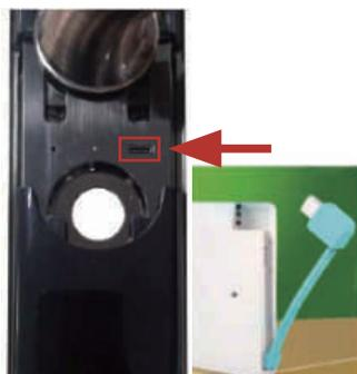
2. 将备用电源的插头插入对应的应急插口，即可实现应急供电开锁功能
