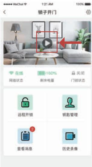
先在门锁上按“3”“#”激活门锁，设备状态显示为在线后，再进行操作。
