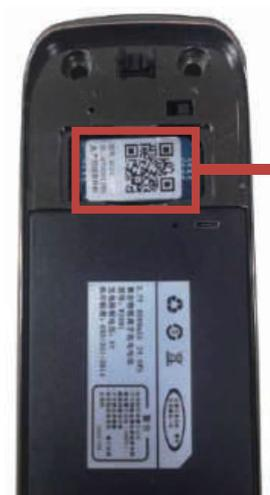
打开门锁后面板，扫描图中位置的二维码
